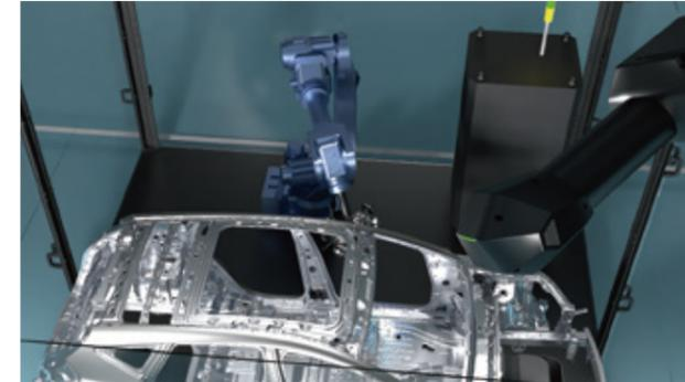
与机器人协同工作，搭建自动化三维测量系统AutoScan-T，实现高效、批量化测量。
