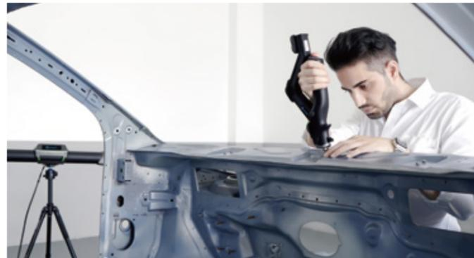
搭配便携式CMM测量光笔T-Probe，支持多测针适配，单点重复性0.030 mm，获取基准孔、隐藏点等关键部位的精准数据。
